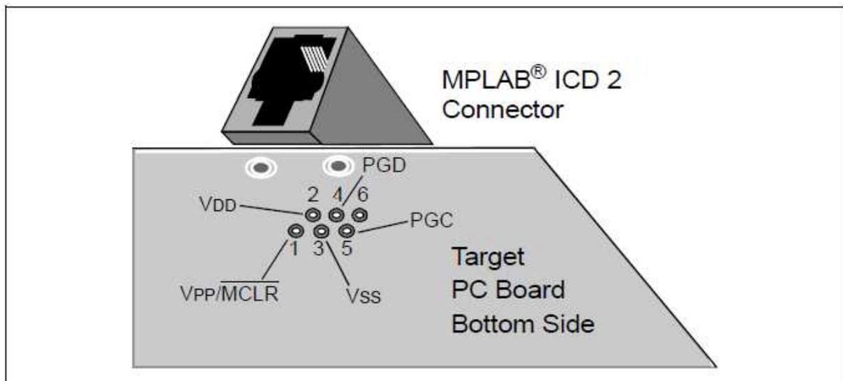
Anschluss des Mini-Pic-Programmiers an das PIC-Entwicklungsboard
