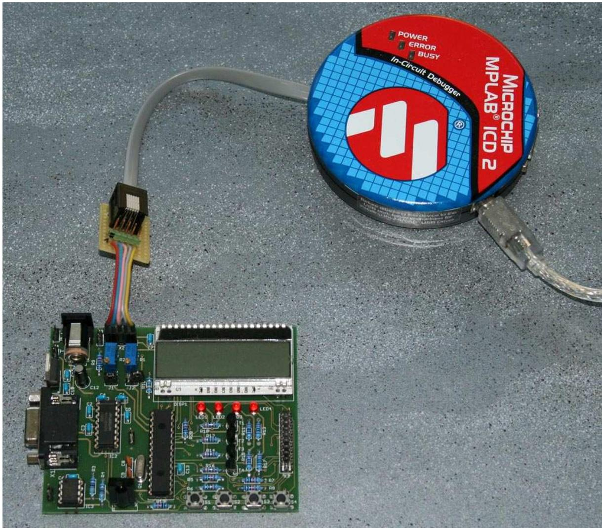
Der ICD2 kann direkt mit dem Entwicklungsboard verbunden werden. Am einfachsten geht dies, indem man sich eine kleine Adapterleiterplatte von dem RJ11 Stecker auf eine Buchsenleiste lötet.
